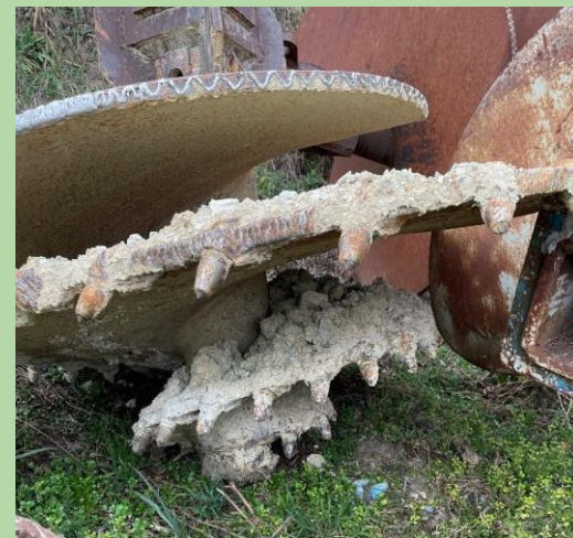
Kőzet-fúrófej; Felőrli a kemény réteget, de nem fejt ki! Így a két fejet ~1 méterenként cserélgetni kell..
